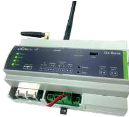
les écarts de températures par rapport aux consignes etc. Localement il peut s'intégrer à une installation de GTB avec le BACnet.
